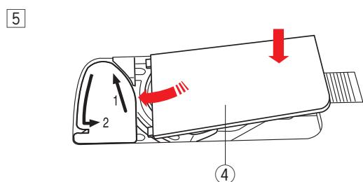
**5** Установите левый край крышки челночного отсека в отверстия.
