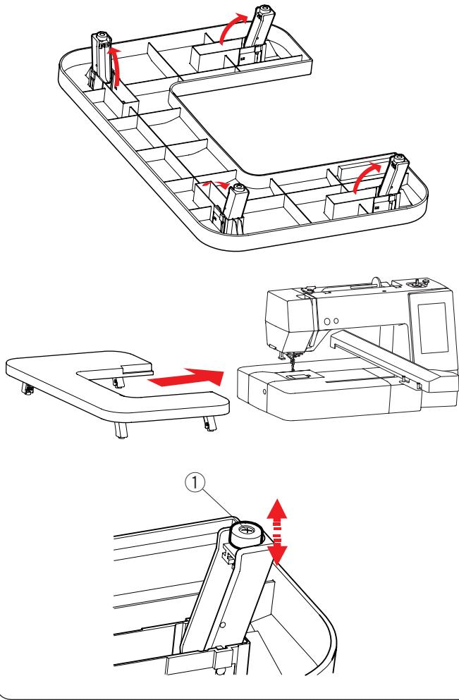
Используйте расширительный столик при работе с вышивальными пяльцами RE20b, SQ20b или RE36b. Поднимите 4 ножки, которые сложены с внутренней части столика. Присоедините расширительный столик к машине.
