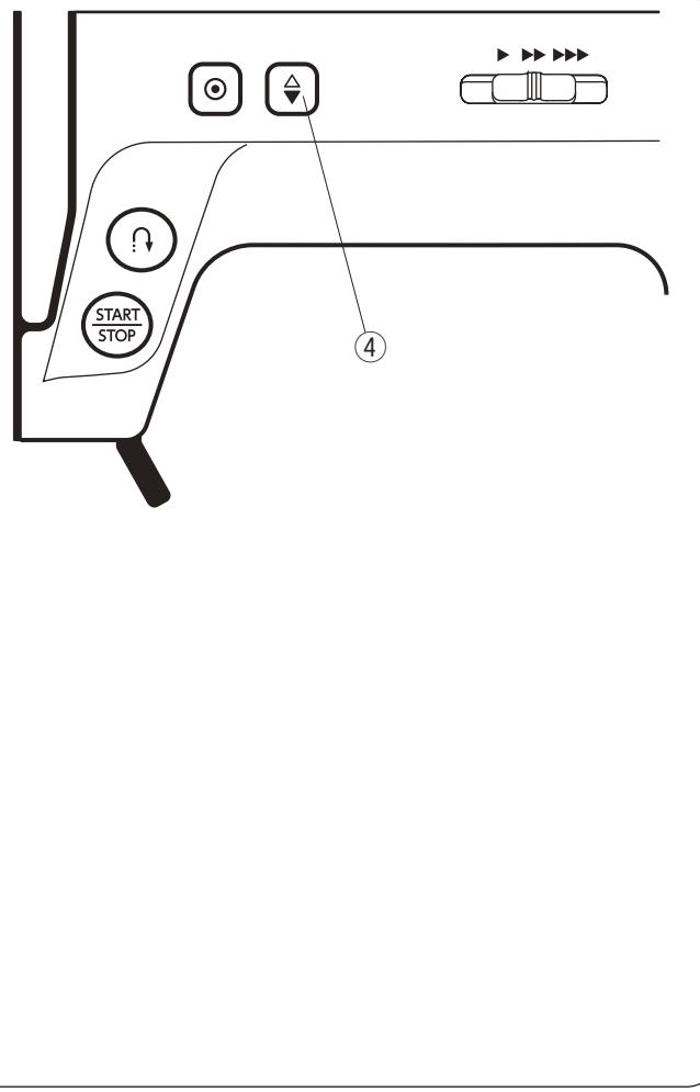
**④ Кнопка подъёма/опускания иглы**
