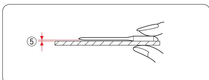
Чтобы проверить качество иглы, положите её плоской стороной на ровную поверхность (игольную пластину, стекло и т.д.).
