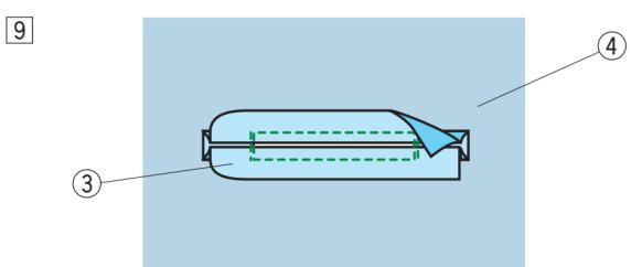
9 Обтачку следует обрезать на расстоянии 1-1,5 см (7/16"–5/8") от отверстия. Углы следует обрезать со скруглением, как показано на рисунке.
