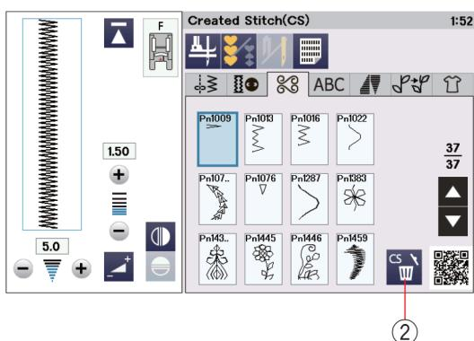
Чтобы удалить образец, нажмите клавишу удаления и выберите образец для удаления.
