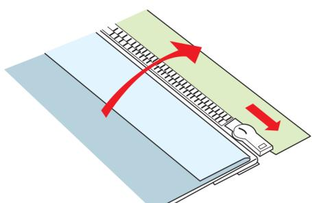
Опустите лапку на верхнюю часть ниже молнии так, чтобы игла пробивала ткань рядом со сгибом и лентой молнии.
