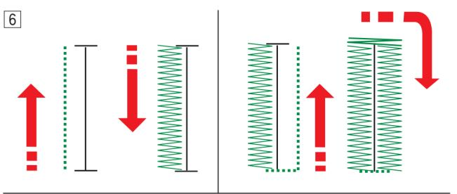
6 Петля будет прошита автоматически в последовательности, указанной на рисунке. По завершении выполнения петли машина остановится автоматически с иглой в верхнем положении. Нажмите кнопку обрезки нити и выньте ткань.
