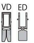
На сенсорном экране при нажатии клавиши двойной подачи отображаются лапка двойной подачи VD и лапка двойной подачи для вшивания молнии ED. Эти лапки используются вместе и приобретаются отдельно.
