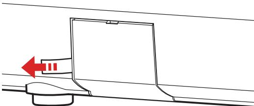
Когда вы запустите машину в первый раз, обязательно снимите защитную ленту с крышки аккумуляторного отсека на задней панели машины.
