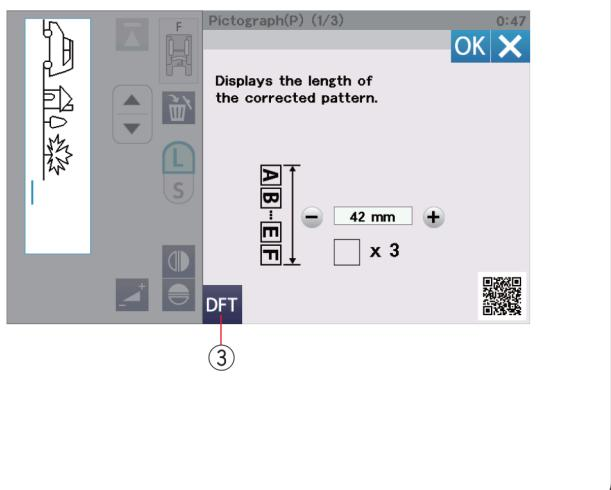
Например, выберите образцы Р10, Р16 и Р5. Теоретическая длина составляет 53 мм. Однако, считанная длина рассчитывается в соответствии с измеренной фактической длиной. В данном случае скорректированное значение равно 42 мм. Нажмите клавишу настроек по умолчанию, чтобы очистить введенную актуальную длину.
