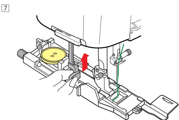
7 После выполнения петли поднимите рычаг ограничителя петли так высоко, как это возможно.
