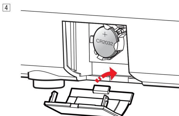
1 Снимите крышку батарейного отсека с помощью отвёртки.
