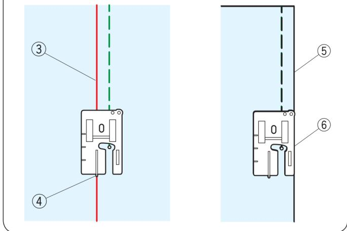
Вы можете сшить изделие с припуском  $1/4"$  от направляющей линии с помощью лапки O для шва  $1/4"$  (без направляющей), как показано на рисунке.
