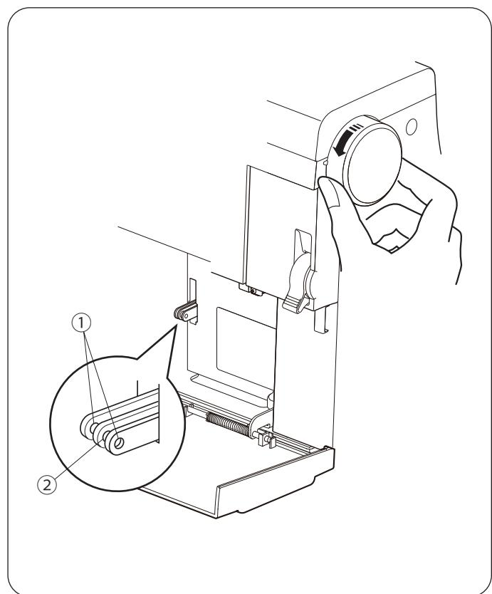
Откройте крышку петлителя, сдвинув её вправо (См. стр. 5). Поворачивая маховое колесо на себя, совместите оба направляющих отверстия ① с глазком на рычаге нитеводителя петлителя ②, как показано на рисунке.
