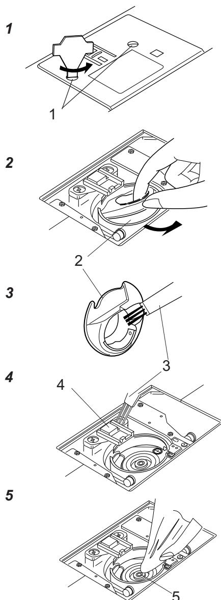
**1** Снимите установочный винт с левой и правой стороны игольной пластины при помощи отвертки, прилагаемой к машине. Снимите игольную пластину.
